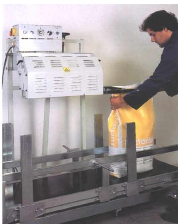
La soldadora va montada sobre una columna y su altura se regula fácilmente, mediante un vis-sin-fin.
